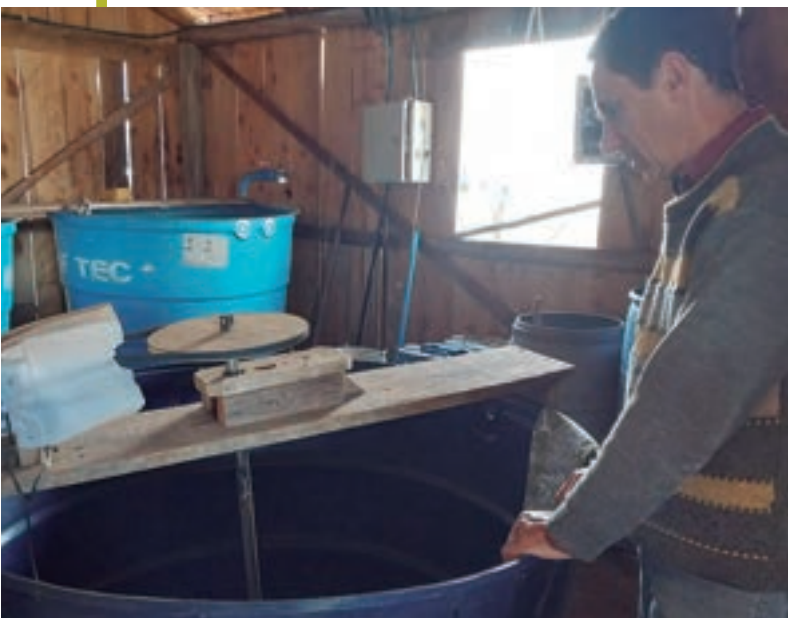
Aerador com motor de máquina de lavar roupa, em caixa d'água, para reprodução de comunidades de microrganismos, no sítio de Marcos Mosquer, 2025
